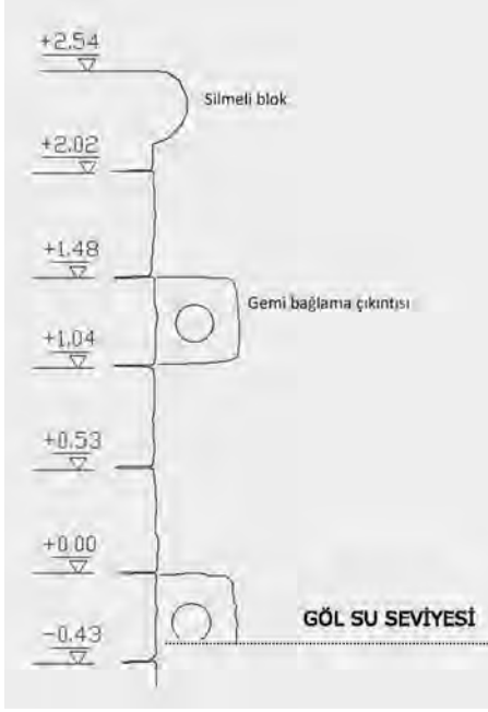
Şekil 11. Temenos duvar kesiti
