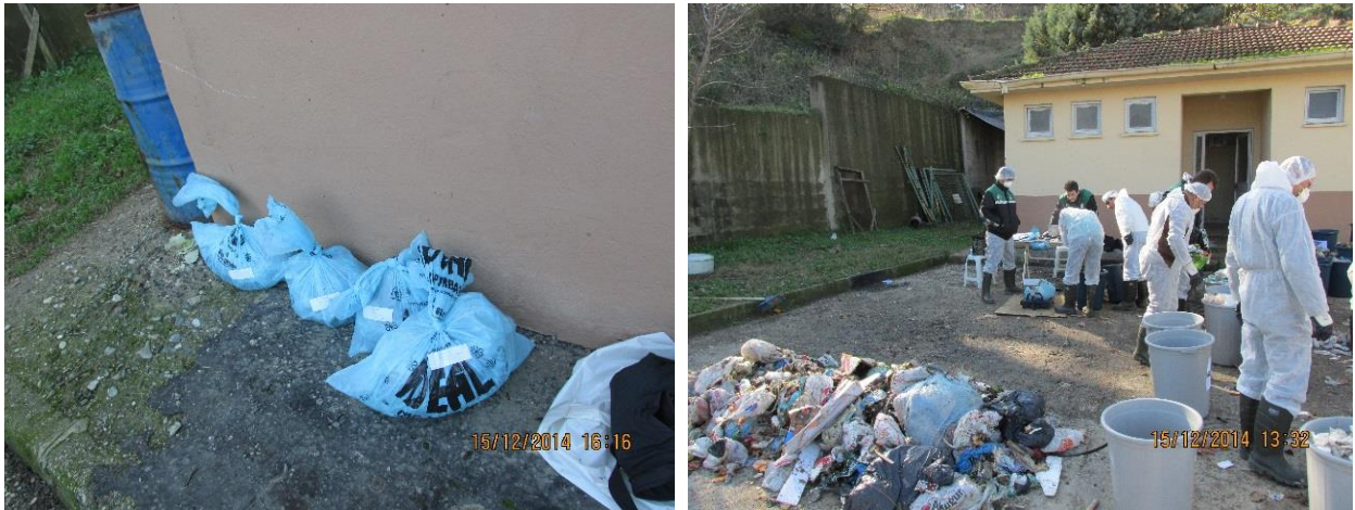
Fotoğraf 6-10 Laboratuvar analizleri için numune alma işlemi ve alınan numunelere atık kodlarının verilmesi
