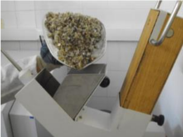
Fotoğraf 6-13 Kaba öğütücüden geçirilen numunelerin ince öğütücüde öğütülmesi
