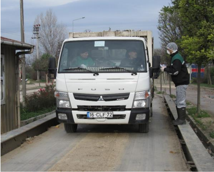
Fotoğraf 6-1 Kentsel katı atık toplama araçlarının kantarda tartılması ve bilgilerin alınması
