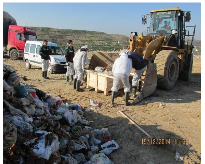
Fotoğraf 6-4 Sınıflandırma çalışması için atıkların numune hacim kabına doldurulması ve sınıflandırma yapılacak yere taşınması
