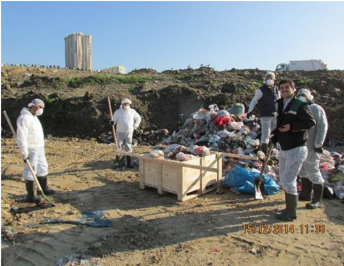
Fotoğraf 6-4 Sınıflandırma çalışması için atıkların numune hacim kabına doldurulması ve sınıflandırma yapılacak yere taşınması
